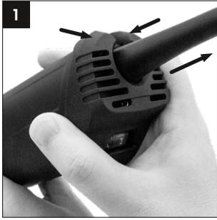
**DE** Lösen sie mit leichtem Druck die Feinstaubschutz-Kappe von der Maschine.
