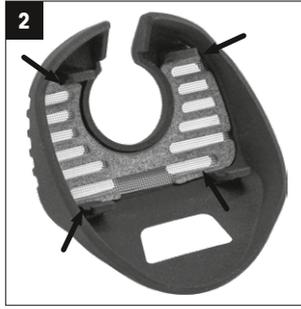
**DE** Entfernen Sie den Filterhalter, indem Sie es mit einem spitzen Gegenstand – wie z. B. ein Schraubendreher – vorsichtig aus den vier Vertiefungen in der Feinstaubschutz-Kappe lösen.
